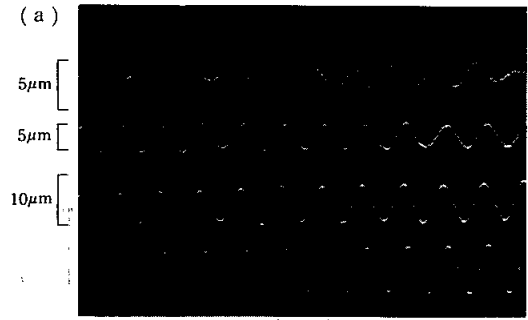
上からバンド変位a部 " " b部 " " c部 鳴き音 ワイヤ張力：3.5kg 車 速：10 km/h
