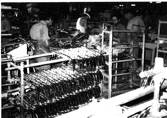
写真1 ロッド式ハンドルバーアッセンブル組立風景
