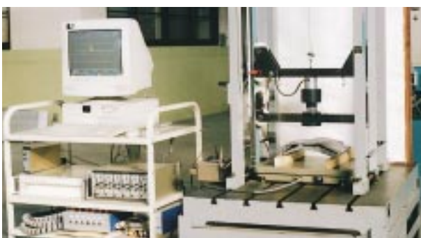
写真1 屋根瓦の破壊試験
