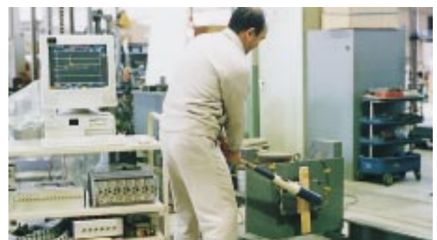
写真2 バットによる打撃試験
