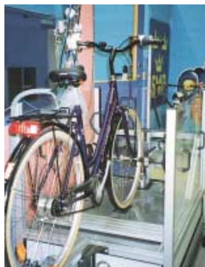
写真2 DIN規定による制動試験機
