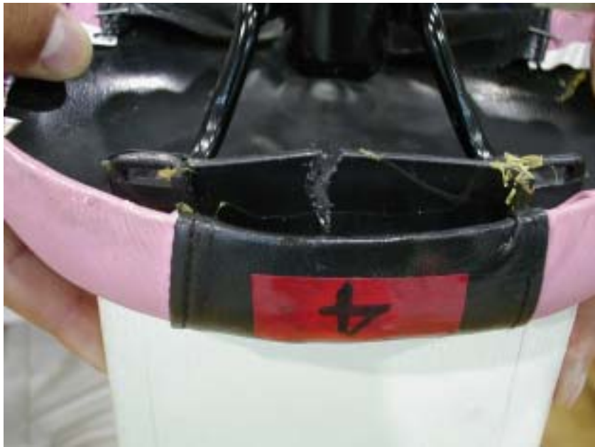
写真6 サドルの破損状況( 4 )
