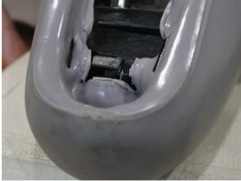
写真5 サドルの破損状況( 3 )
