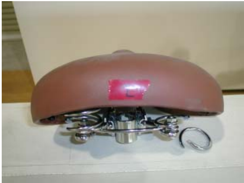
写真4 サドルの破損状況( 2 )
