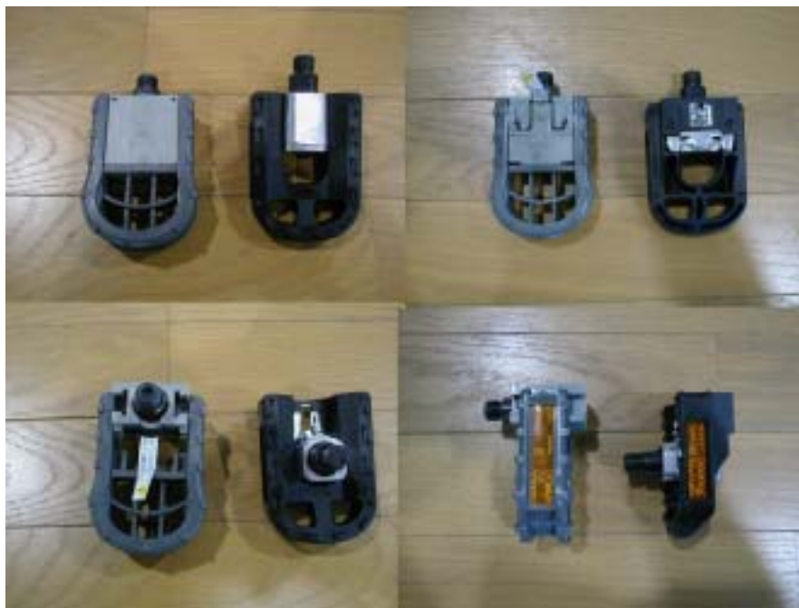
写真2 折りたたみ車用ペダル 下段 折りたたんだ状態
