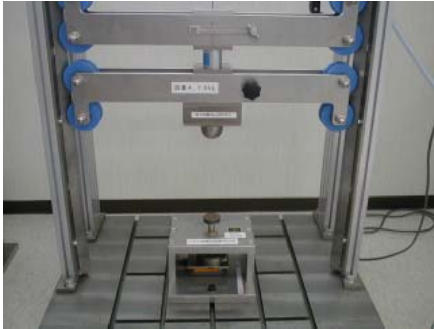
写真5 合成樹脂ペダル耐寒試験状況
