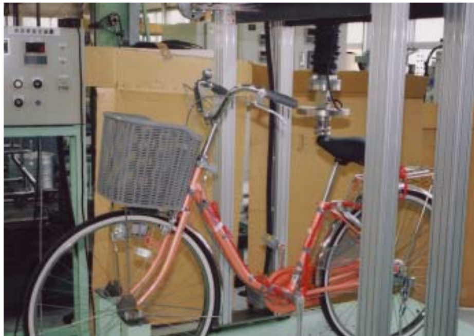
写真2 サドルの固定試験状況
