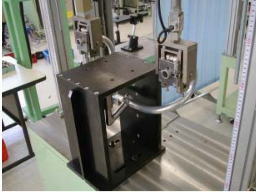
写真1 ハンドル繰返し荷重試験状況
