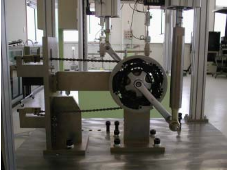
写真1 クランクの繰返し疲労強度試験状況
