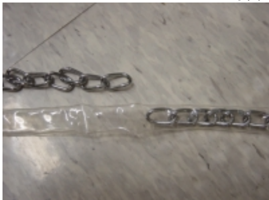
写真15 チェーン錠 (No.9) の破損
