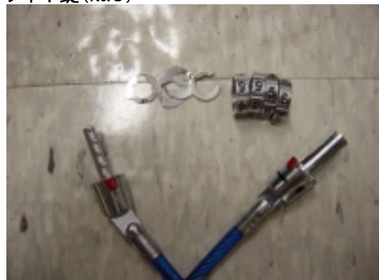
No.7 本体(ダイヤル部)破損
