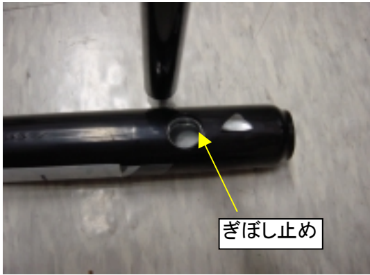
ハウジングの破損
