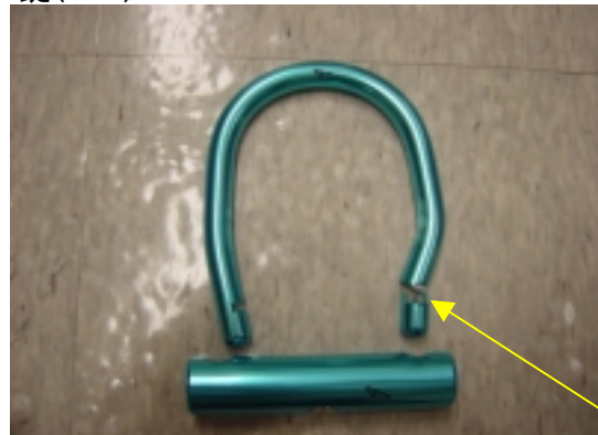
シャックル破損
