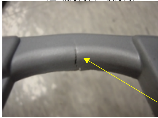
写真17 リング錠(剛性タイプ) (No.13) 本体破損
