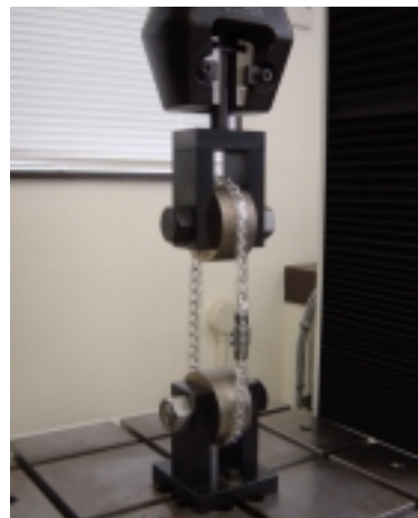
写真7 試験状況(チェーン錠)
