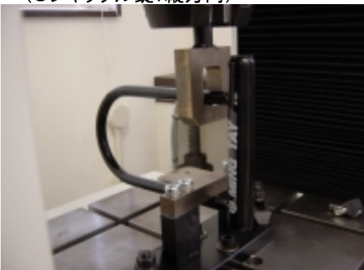
写真5-2 試験状況(Uシャックル錠:横方向)
