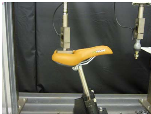
写真2 ENサドルの疲労試験
