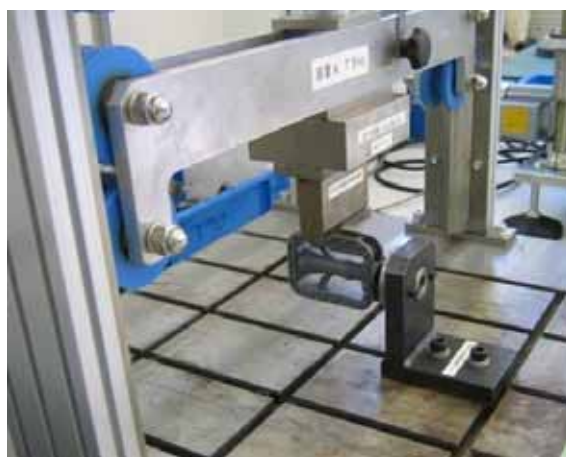
写真C-3 ペダルの耐衝撃試験状況
