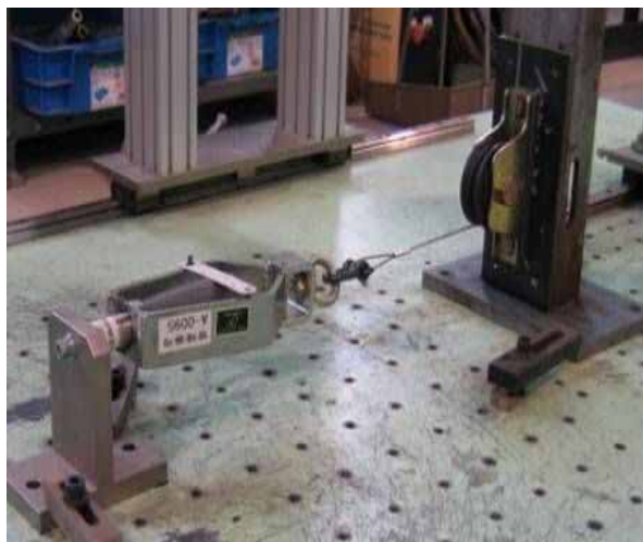
写真C-1 にぎりの離脱力試験状況
