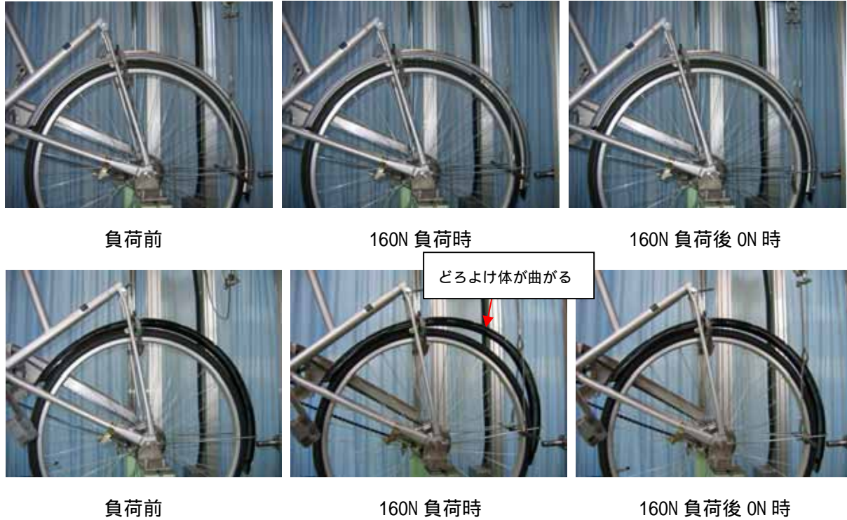
写真7 EN 第1段階 変形の様子(後輪) [上段: No.1 下段: No.8]
