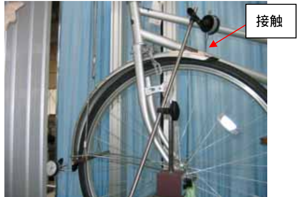
写真6 最大負荷時の接触の様子 (No.1)
