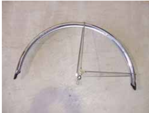
No.6： ステンレス製どろよけ体 + ステンレス製ダブルステー（車輪の径の呼び 26、後輪のみ）
