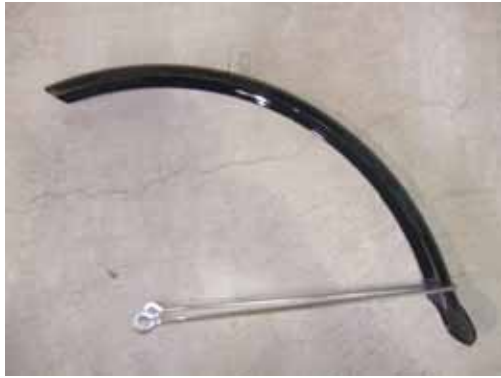
No.8 : 合成樹脂製どろよけ体 + ステンレス製ステー (車輪の径の呼び 26、左 : 前輪 / 右 : 後輪)
