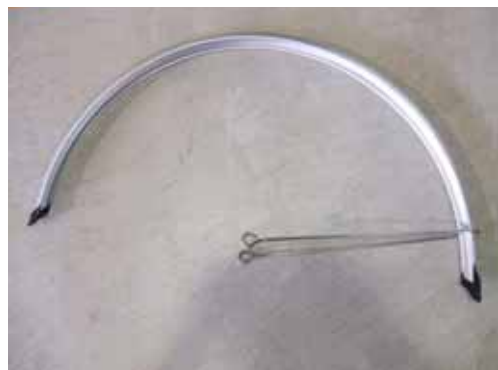
No.9 : 鉄製どろよけ体 + ステンレス製ステー (車輪の径の呼び 27、左 : 前輪 / 右 : 後輪)
