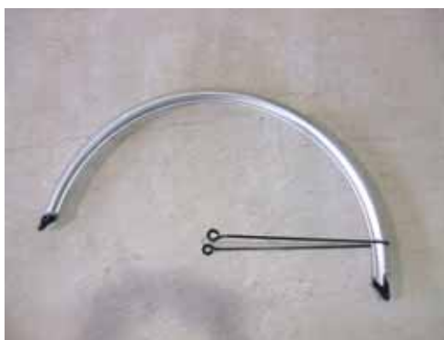
No.3：鉄製どろよけ体+鉄製ステー（車輪の径の呼び26、左：前輪 / 右：後輪）
