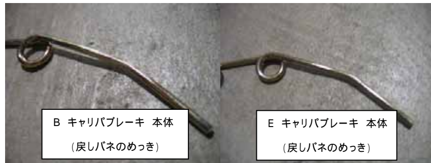
写真 5 パーツ写真（六価クロムが基準値を超えて含有していた）
