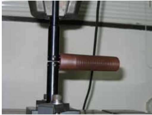
写真 7 にぎりの引張強さ試験状況
