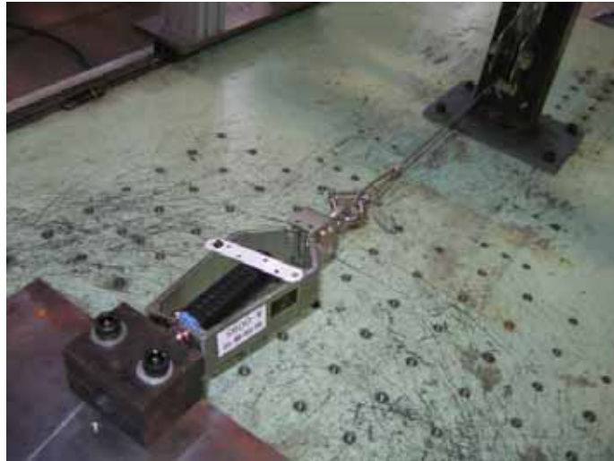
写真 8 にぎりの離脱力試験状況
