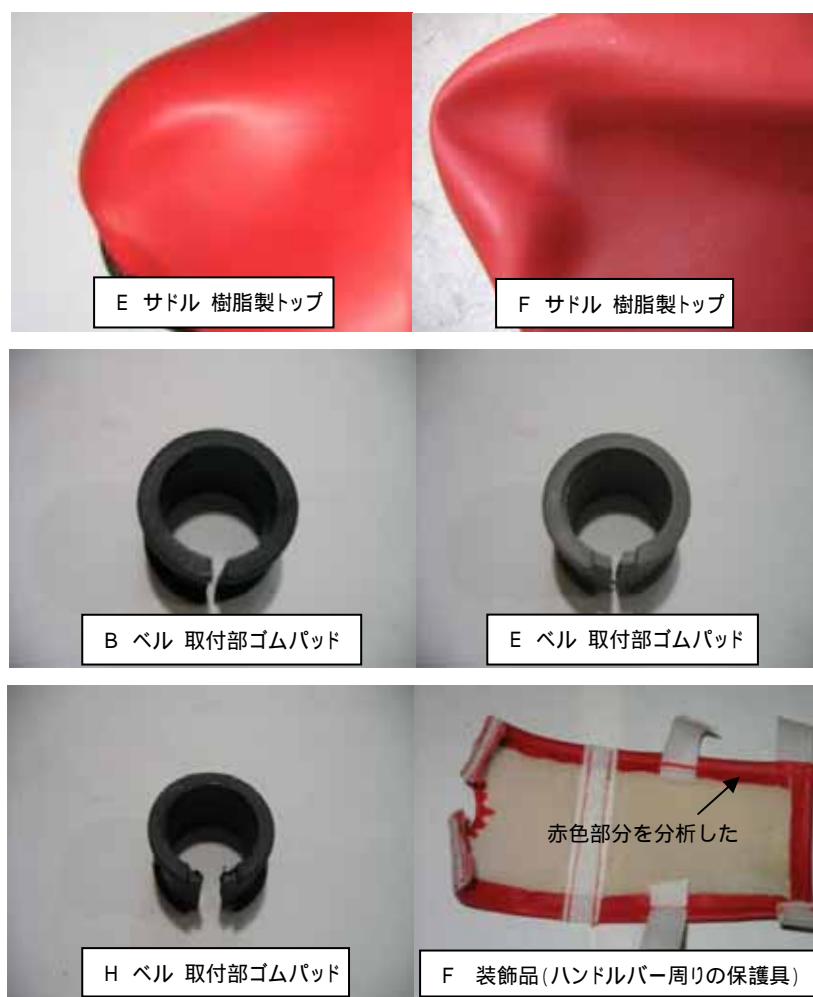
写真 4 パーツ写真（鉛が基準値を超えて含有していた）
