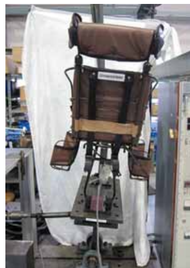
写真4 側方動的強度試験
