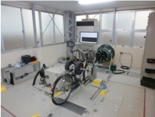
写真 1 シャーシダイナモメータ外観
