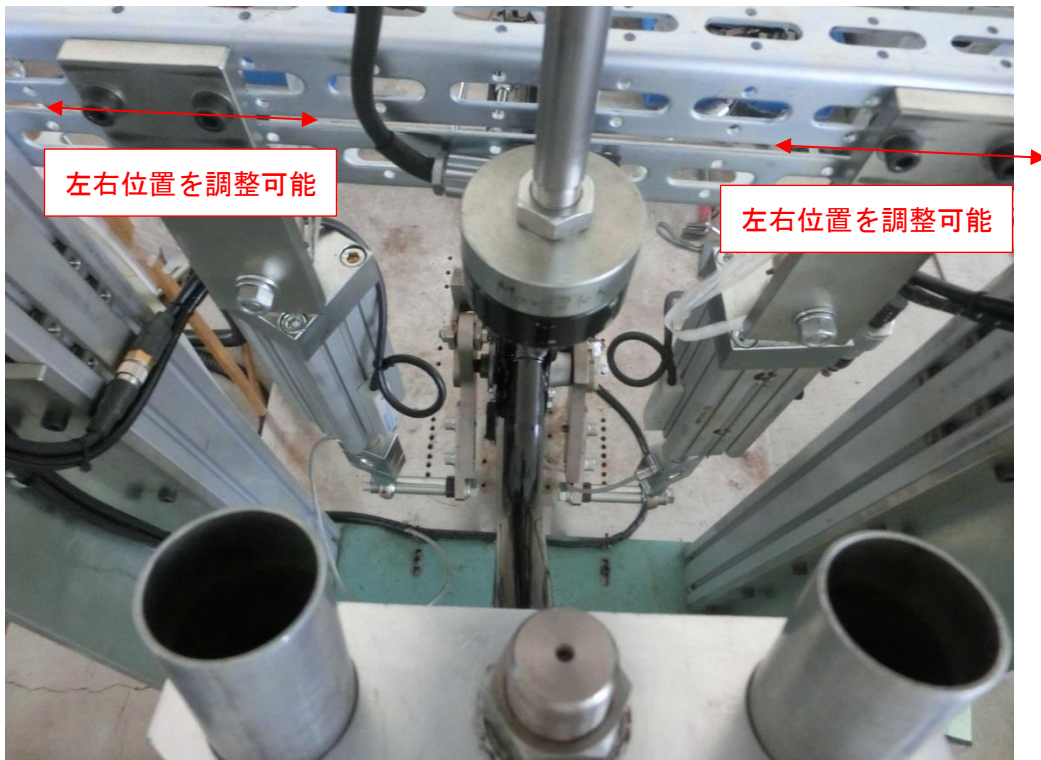
写真1 シリンダー取り付けの様子
