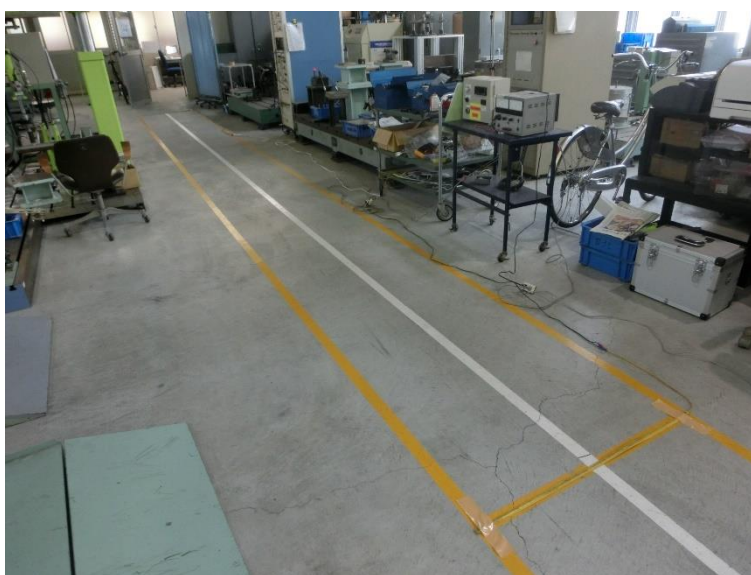
写真 3 走行路（10 m の通過時間測定部分）
