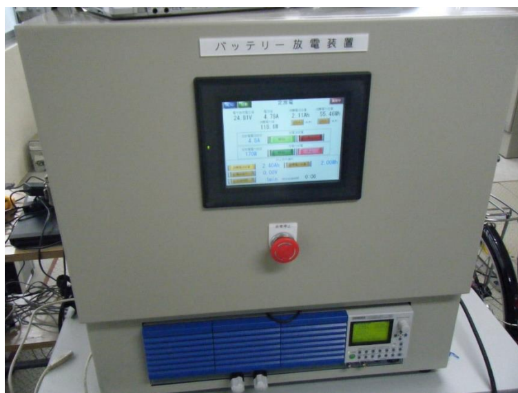
写真 1 バッテリー放電装置
